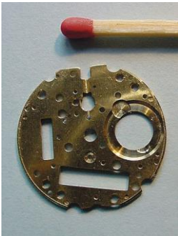
Uhrenplatine Ø 24 x 0,8 mm Span-zu-Span-Zeit 4,5 s bei automatischem Werkstückwechsel
