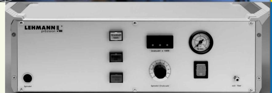
**LS 30** Unser HFS-Steuergerät mit Pulsamplituden-Modulation (PAM) sorgt für lange Lebensdauer des DC-Motors. Ein voll digitalisierter Regler mit Lastkompensation bietet hohe Drehzahlkonstanz und vermeidet thermische Probleme. Die Steuerung und Überwachung von Motor und Umrichter übernimmt ein 32-Bit-Mikroprozessor. Integrierte Ein- u. Ausgänge zur Fernsteuerung der Hochfrequenzspindel von der Werkzeugmaschine aus sowie Sicherheitsfunktionen. 19"-Tischgehäuse oder Schaltschrankmontage.
